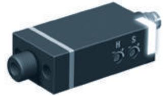
Les vacuostats électroniques série PSP intègrent en standard le réglage de seuil et d'hystérésis. La gamme est équipée de trois raccordements au vide (G1/8"-Mâle, M5-Femelle ou embase M5-Femelle) et de deux connexions électriques (câble 2 mètres et connecteur M8).
